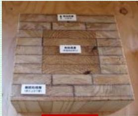
国産スギ材ラミナにインサイジングを施し、難燃薬剤を含浸させた難燃処理層で荷重支持部を被覆
