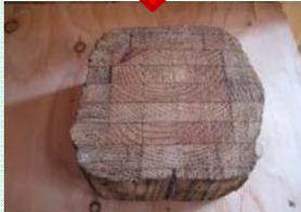
断熱性の高い炭化層になり、内部への燃焼進行を抑制
